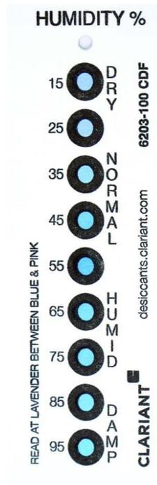
Zur ca. Überprüfung eines Klimas (die Genauigkeit ist geringer als 10% rF):
