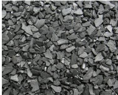
**Aktivohle K48** ist eine mit Wasserdampf aktivierte Kornaktivkohle auf der Basis von Kokosnussschalen und erfüllt den Anforderungen lt. DIN12905-1, DIN12905-2 und NSF61.
